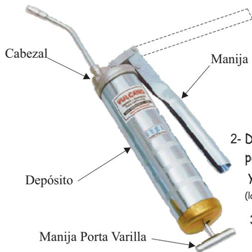
1- Desenroscar el Cabezal del Depósito.-
